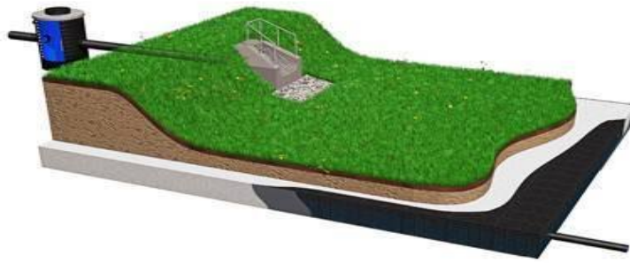
Рисунок 1 – Схема устройства бассейна удержания
