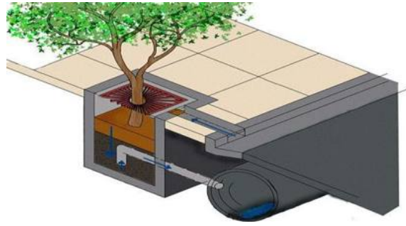
Рисунок 36 – Схема устройства коробчатых фильтров с посадкой деревьев
